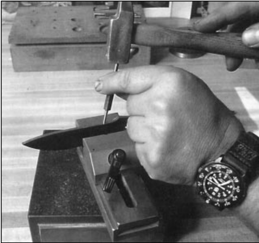
Фото 4. Наметьте центр отверстия на обухе клинка под винт для крепления диска под большой палец.
