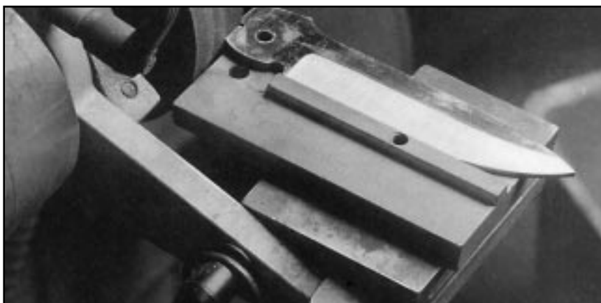
Фото 18. Этот держатель я сделал для того, чтобы шлифовать скос на торце пятки клинка под углом 8,5^\circ по отношению к контактному ролику.
