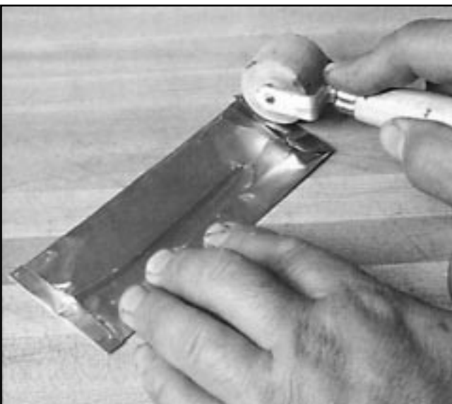
Фото 5. Тщательно оберните клинок фольгой перед термообработкой, стараясь не оставлять внутри воздуха.
