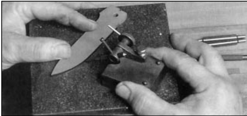
Фото 11. Разметочным инструментом нанесите на лезвийную грань две параллельные разметочные линии. Резец на рейсмусе – твердосплавный для разметки закаленных сталей. Расстояние между линиями примерно 0,030 дюймов, которое далее при полировке уменьшится до 0,020 дюймов.
