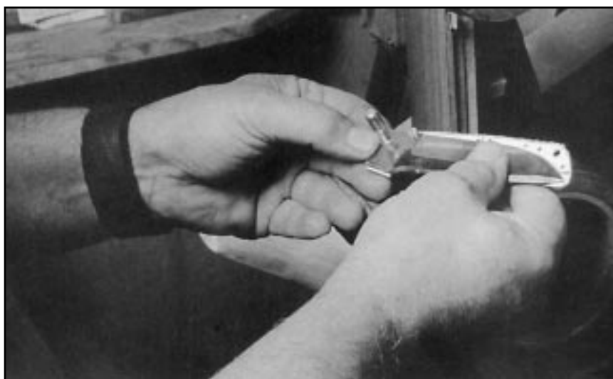
Фото 20. Грубая проверка положения клинка относительно плашек в закрытом положении: острие не должно выступать за пределы плашек, а сам клинок должен убираться вовнутрь, не касаясь разделительной проставки.
