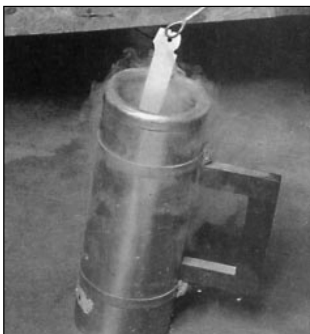
Фото 8. Криогенное охлаждение клинка в жидком азоте.
