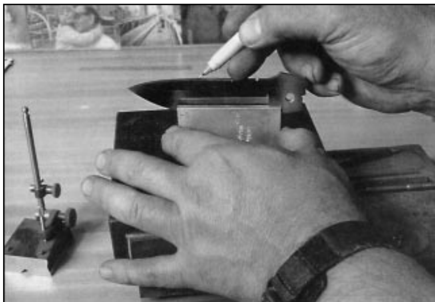
Фото 15. Нанесите на клинок разметку, определяющую границы шлифования полуторной заточки клинка или фальшзаточки.
