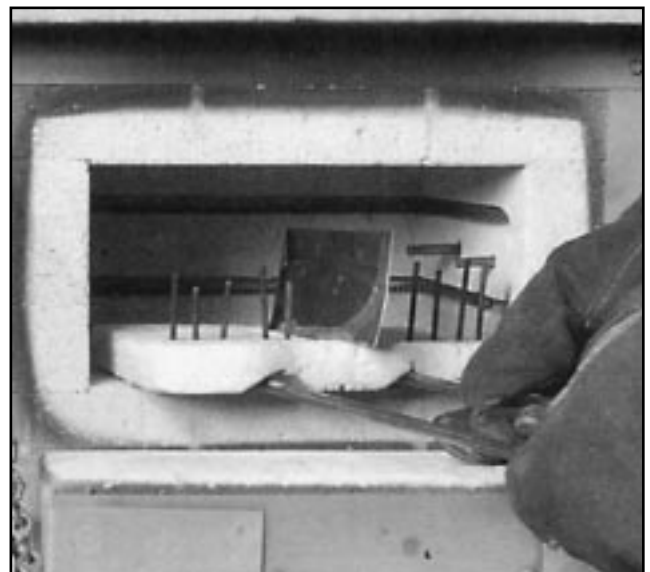
Фото 6. Поместите упакованный клинок в подогретую печь в вертикальном положении, лезвием вниз.
