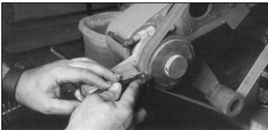
Фото 17. Шлифовка скоса торца пятки клинка.
