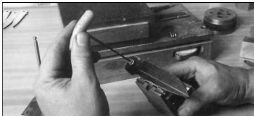
Фото 13. При шлифовке клинков я использую держалки (см. гл.9). При работе это помогает удерживать клинок максимально ровно при минимуме усилий.
