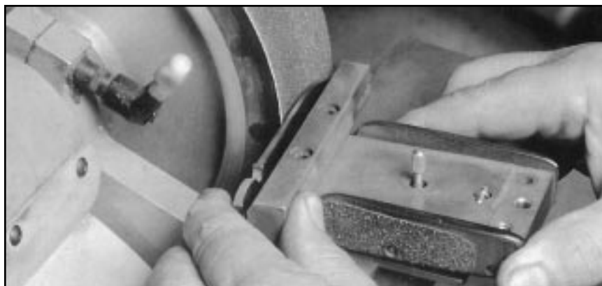
Фото 14. Вышлифуйте спуски на обеих сторонах клинка на новой крупнозернистой абразивной ленте. Убедитесь, что скосы одинаковы с обеих сторон.
