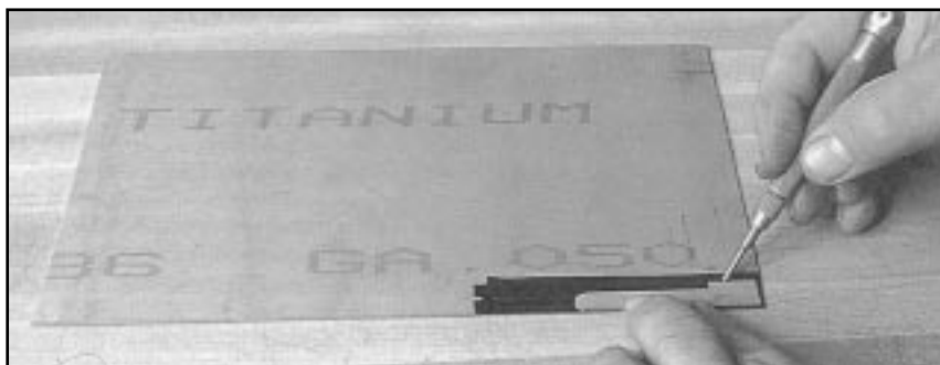
Фото 1. Очертите контур стопора на листе титанового сплава.
