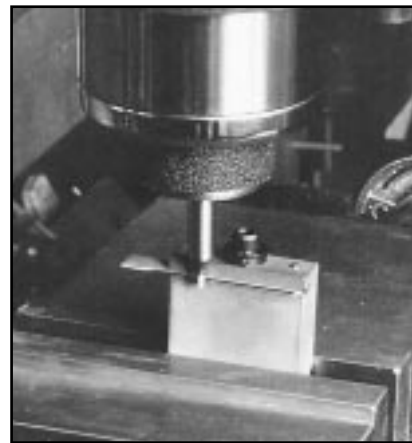
Фото 4. Альтернативным способом фрезерования краев стопора является использование специальной фрезы с головкой в форме «ласточкин хвоста».
