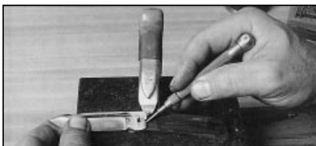
Фото 6. Перенесите профиль пятки клинка на предварительно закрашенную маркером внутреннюю поверхность плашки.
