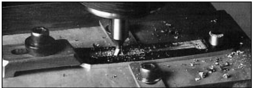
Фото 9. Фрезерование закругленной части слота с помощью фрезы с головкой в форме «ласточкиного хвоста».
