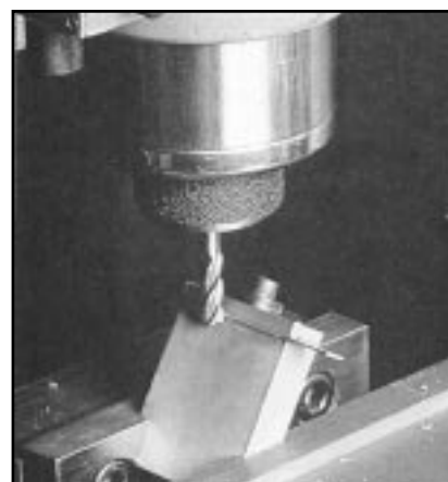
Фото 3. Фрезеруйте края стопора под углом 60 градусов, используя специальный держатель.
