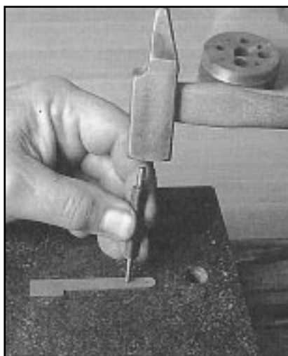
Фото 2. Накерните место сверловки отверстий под два сборочных винта (случай, когда стопор крепится к плашке резьбовым соединением).
