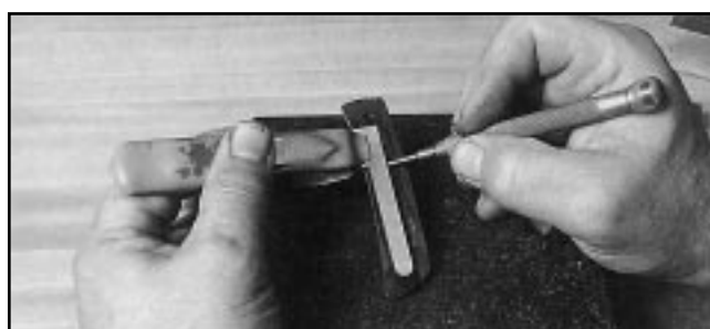
Фото 7. Перенесите профиль стопора на плашку.
