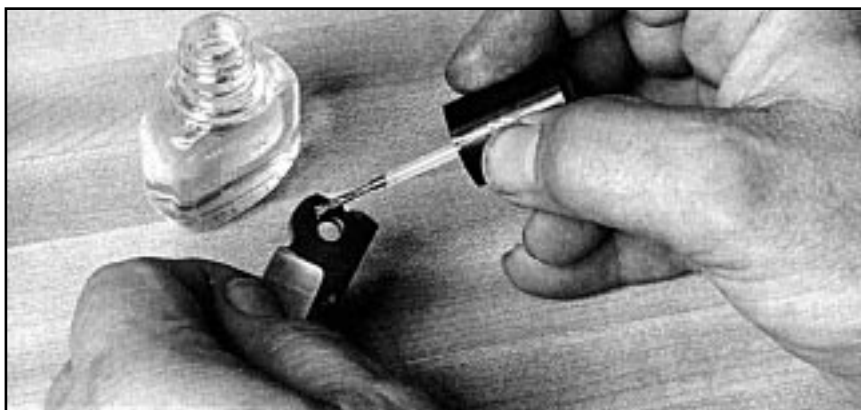
Фото 11. Покраска частей, на которые будет нанесен защитный слой, и тем самым защита их от травления.
