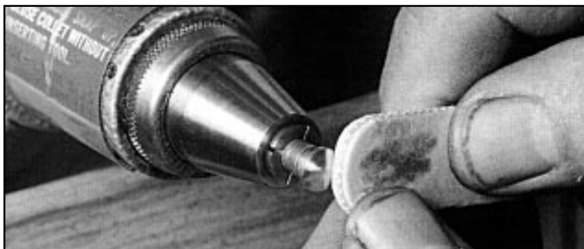
Фото 1. Полировка головок винтов и шарнирного винта – самый простой способ отделки ножа.
