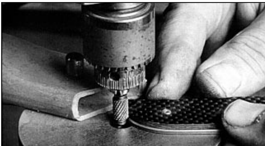
Фото 4. Стачивание (затемнение) накладки с помощью карбидной фрезы и шарикоподшипниковое направляющее устройство, удерживающее фрезу на фиксированном расстоянии от края рукоятки. Обратите внимание на вакуумный наконечник прямо напротив фрезы.
