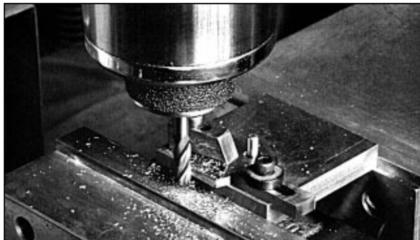
Фото 9. Обрабатывайте фрезой обе проставки вместе (отверстия под штифт должны совпасть точно), чтобы они идеально подходили с обеих сторон ножа.
