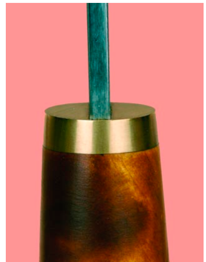
Соосность рукоятки и лезвия после насадки должна быть идеальна
